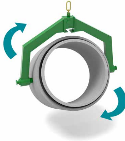
Rotera röret runt sin egen axel och bromsa in när röret befinner sig i horisontellt läge
