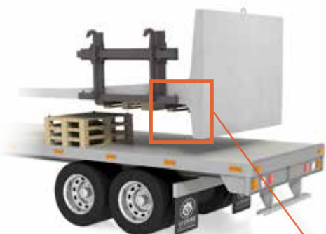
Fig 2.4 Lossning med gafflar, lyft med pall mellan stödmur och gafflar.
