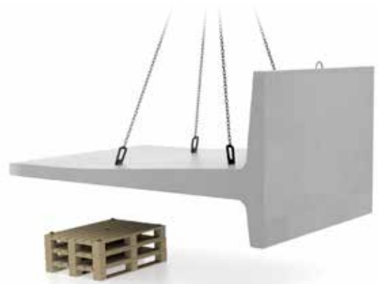
Fig 3.1 Lyft av T-stödmur i alla ankarpunkter.
