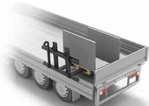
Fig 1.1 L-stöd skall alltid lastas med den höga sidan av muren mot truckstativet.
