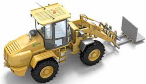
Fig 1.1 L-stöd skall alltid lastas med den höga sidan av muren mot truckstativet.
