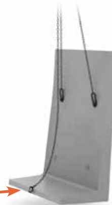
Fig 1.3 Vid lossning och montage lyfts stödmuren i kulankare och balanseras med hjälp av wiresling.
