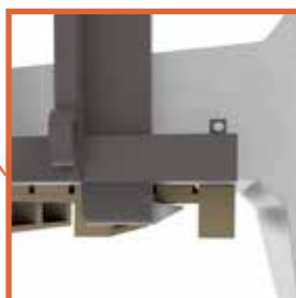
Fig 2.5 Lossning med kulhandskar och lyftkedjor av en liggande T-stödmur över 3meter hög.
