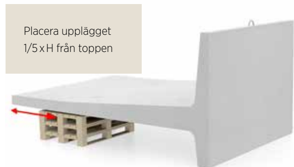
Fig 3.2 Placering av pallar under T-stödmur
