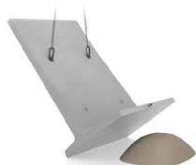
Fig 3.4 Våldsamma ryck vid resning av T-mur kan motverkas med dämpande material-
