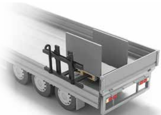
Fig 1.2 L-stödmurar ska lastas stående med långsidan av pallen mot långsidan av lastbilen.
